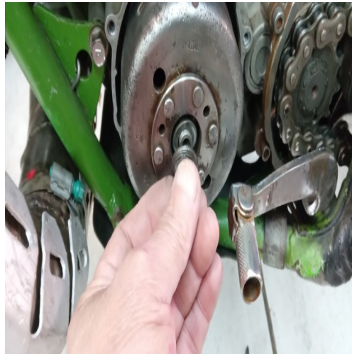
fig. 2 colocar volante magneto
